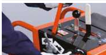
REGOLAZIONE PROFONDITÀ DISCO IDRAULICA O MANUALE
