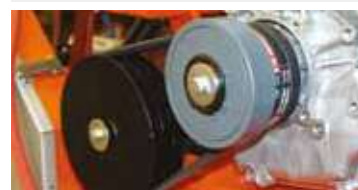
DISPOSITIVO CENTRIFUGALE SULLA FRIZIONE
