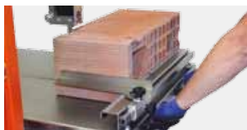
SPINTA MANUALE PER AVANZAMENTO
