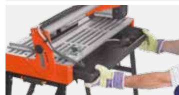
VASCA DELL'ACQUA IN PLASTICA RIMOVIBILE
